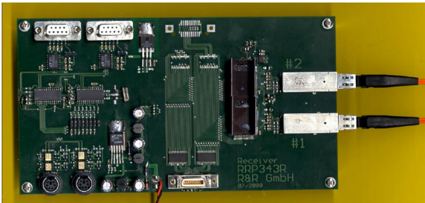
**R&R Lichtwellen-Leiter Remote-Box System für TFT-Displays RR-P-343R/T**
