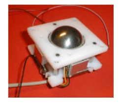
Schnittstelle PS2, Mini-DIN-06 Stecker mit 3 m Kabel
