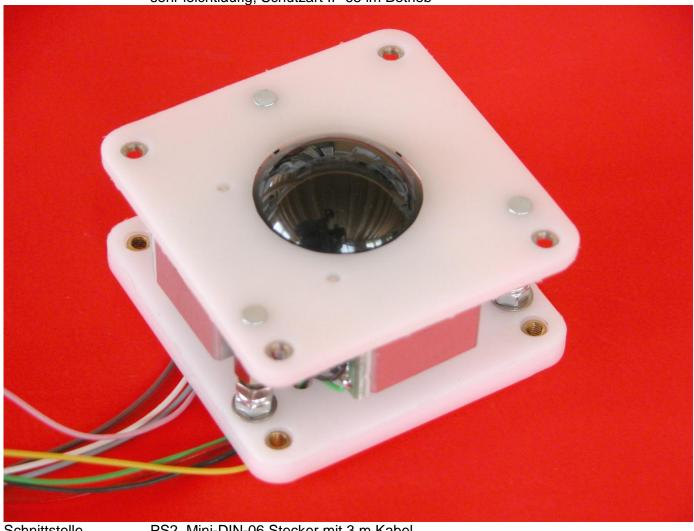
PS2, Mini-DIN-06 Stecker mit 3 m Kabel Schnittstelle
