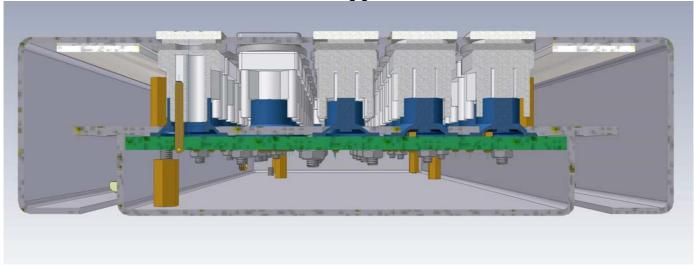
Schaltelement langlebige Silikonschaltmatten mit deutlichem Druckpunkt
