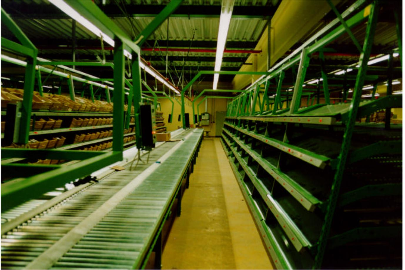
Die Adressen können aus einer Referenztabelle entnommen werden. Z. B. Zone 'n' hat die Pickfächer 'a' bis 'b'. Über den zentralen Steuerrechner der Kommissionier-anlage werden die Pickaufträge an die Zonenterminals überspielt. Der Steuerrechner verfügt über ein Interface mit n RS422 Schnittstellen, an die die Zonenterminals angeschlossen sind. Der Karton läuft über die Anlage und wird in einer Warteschlange (Fassungsvermögen der Zone) vor jeder Zone durch einen Schieber aufgehalten.
