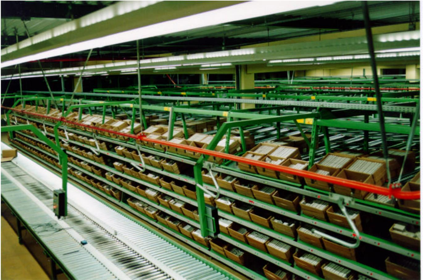
Die Anlage (siehe Foto) besteht aus 6 Durchlaufregalen mit insgesamt 1865 Pickfächern. Zu der Anlage gehört die entsprechende Fördertechnik, Palettenlager, Verloaderampen etc.
