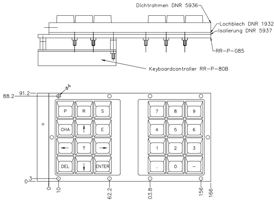
Die Mechanik und die Elektronik, z.B. Position der Stecker Steckerbelegung etc. sind rückwärtskompatibel. D.h. der neue Controller RR-P-80B funktioniert mit dem früher gelieferten Tastaturmodul mit RR-P-85 bzw. das neue Tastaturmodul mit RR-P-85A kann mit dem alten Controller RR-P-80 betrieben werden.
