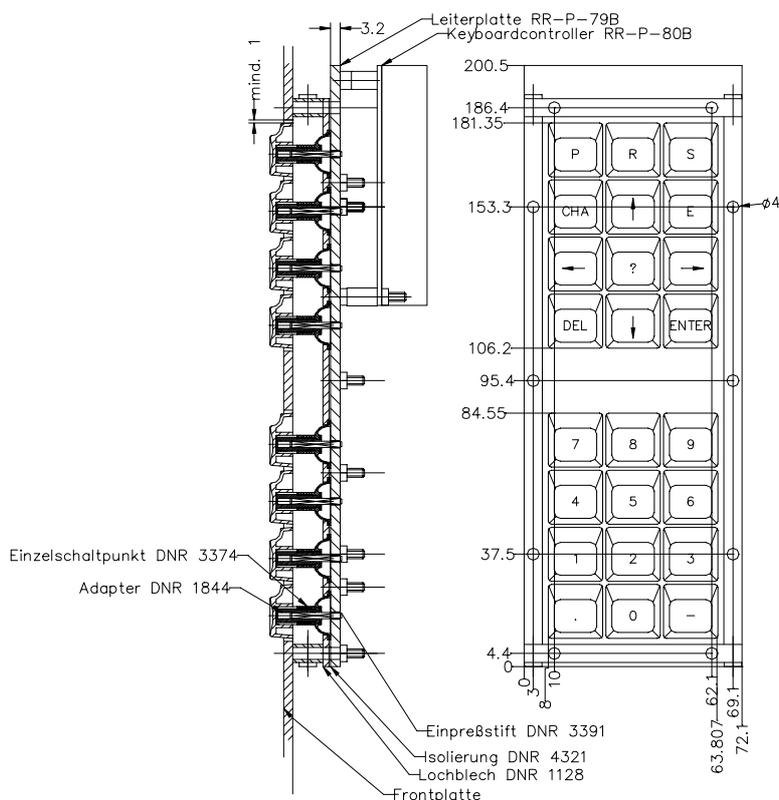
Die Mechanik und die Elektronik, z.B. Position der Stecker Steckerbelegung etc. sind rückwärtskompatibel. D.h. der neue Controller RR-P-80B funktioniert mit dem früher gelieferten Tastaturmodul mit RR-P-79 bzw. das neue Tastaturmodul mit RR-P-79B kann mit dem alten Controller RR-P-80 betrieben werden.
